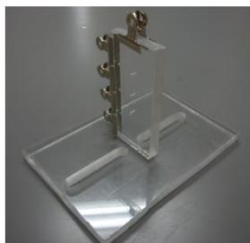
図 1：糸通し作業測定装置
